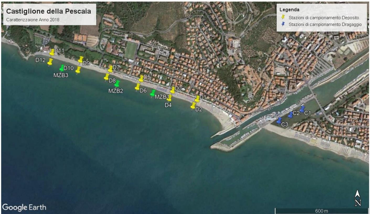
Figura 5. Planimetria (1) relativa al ripascimento del litorale di Castiglione della Pescaia con le sabbie provenienti dalla spiaggia in sinistra idraulica davanti alla foce del fiume Bruna, 2018 – 2019.
